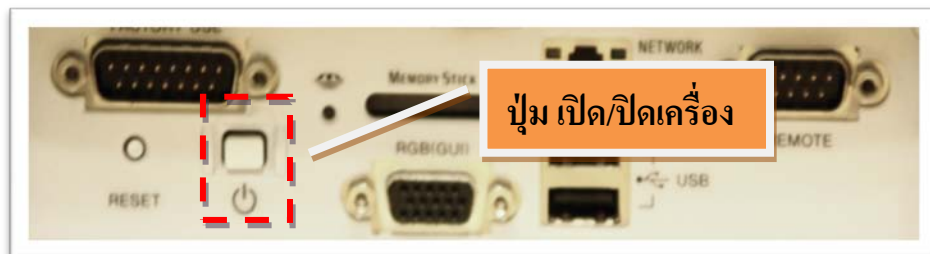
รูปที่ ๒ ภาพบริเวณด้านข้างซ้ายของตัวเครื่อง แสดง ปุ่มเปิด/ปิดเครื่อง
